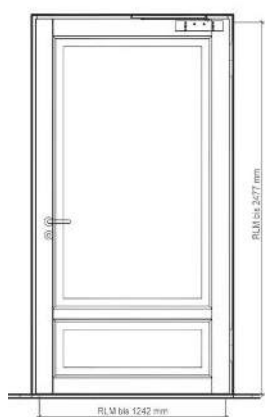
Ansicht Typ 03.01 Denkmalschutztüre Protector 48 mm VKF Nr. 30283
